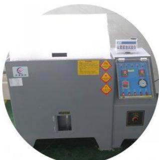
盐雾腐蚀测试仪
